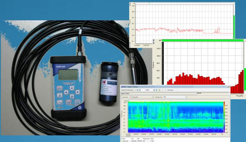
Il clima acustico degli impianti di produzione e delle pertinenze è determinato tramite griglie di punti di misura, con strumentazioni di classe 1 in grado di svolgere misure conformi alle prescrizioni del DM 16/03/1998.
